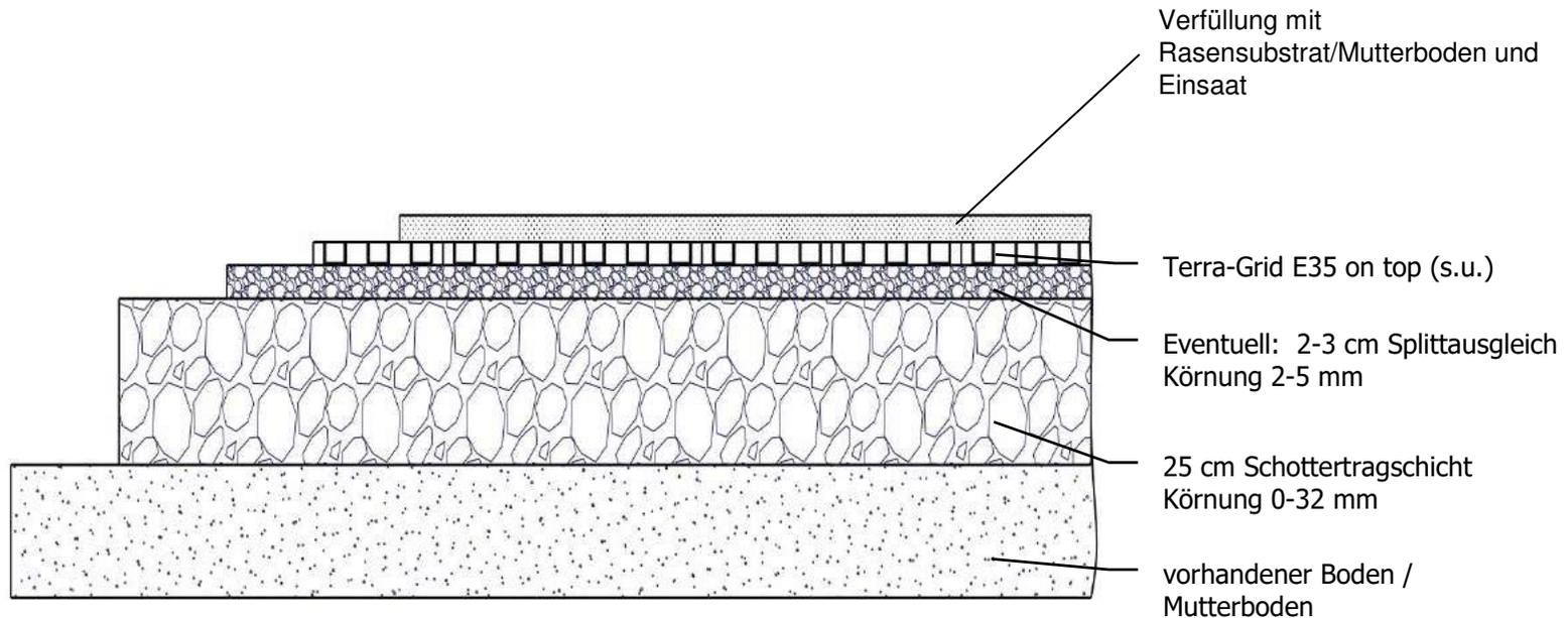
Dieser Aufbau eignet sich besonders gut für Bereiche, welche auch mit schwerem Gerät befahren werden.
